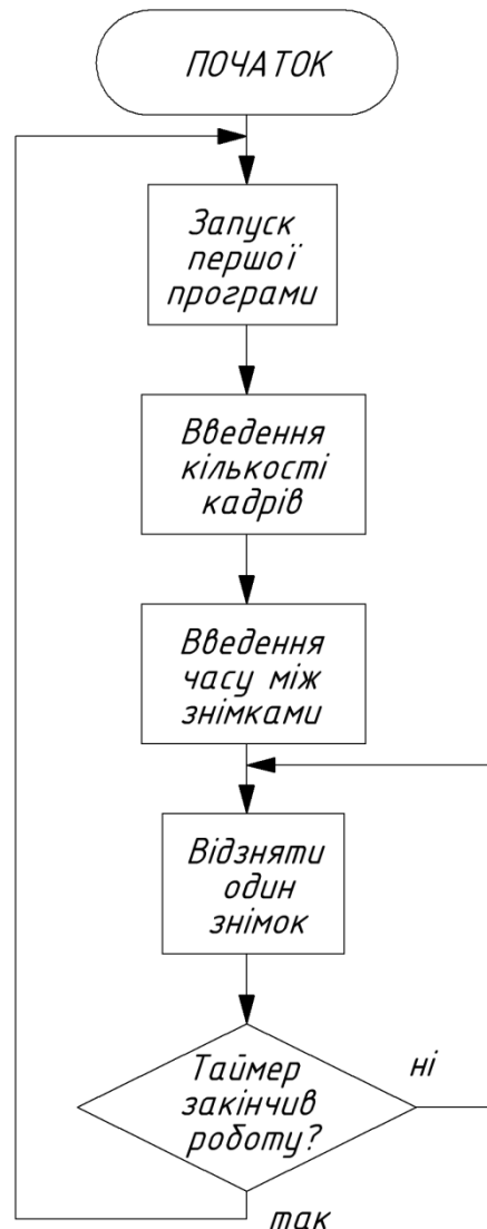
Рисунок 5.2 – Блок схема першої підпрограми першого режиму роботи пристрою
