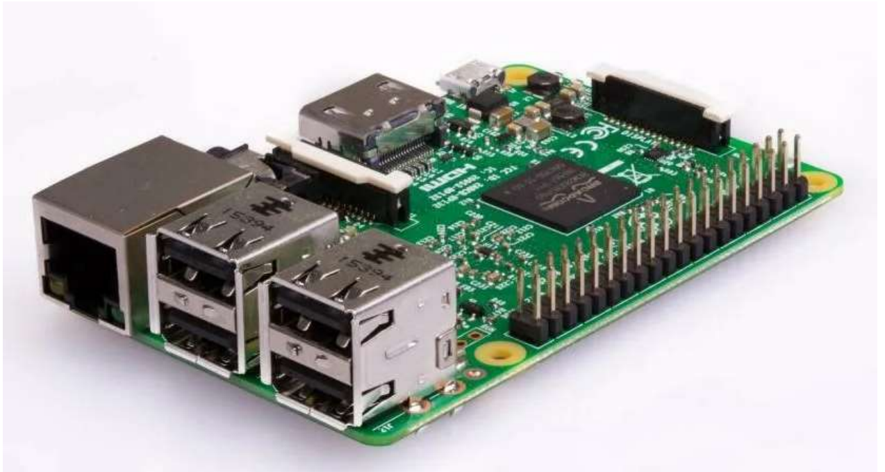
Рисунок 1.4 – Зовнішній вигляд одноплатного комп'ютеру RaspberryPi
