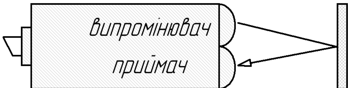
Рисунок 1.4 – Структурна схема моноблочного оптичного датчика
