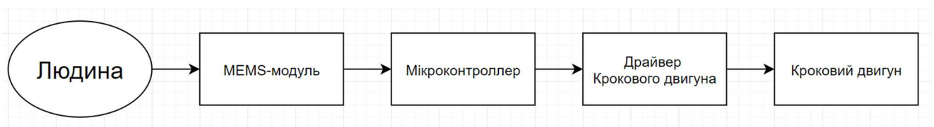
Рисунок 1.1 – Структурна схема системи управління кроковим двигуном на основі MEMS-маніпулятора
