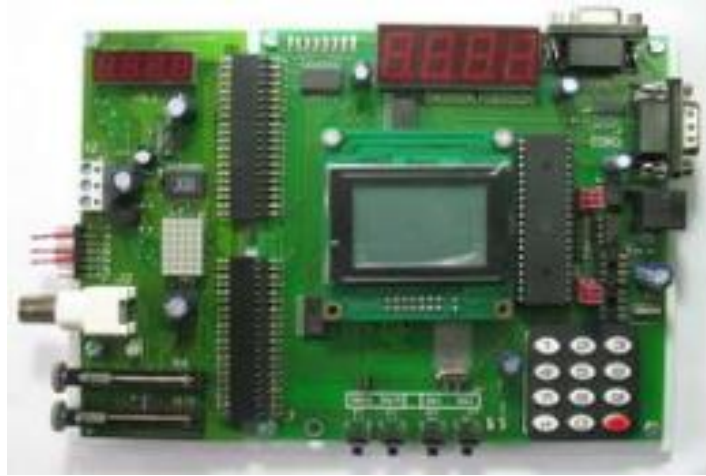
Рисунок 2.1 – Програмно-апаратний комплекс «EV8031/AVR»
