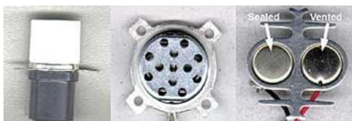
Рис. 2.6 – Теплопровідні датчики абсолютної вологості
