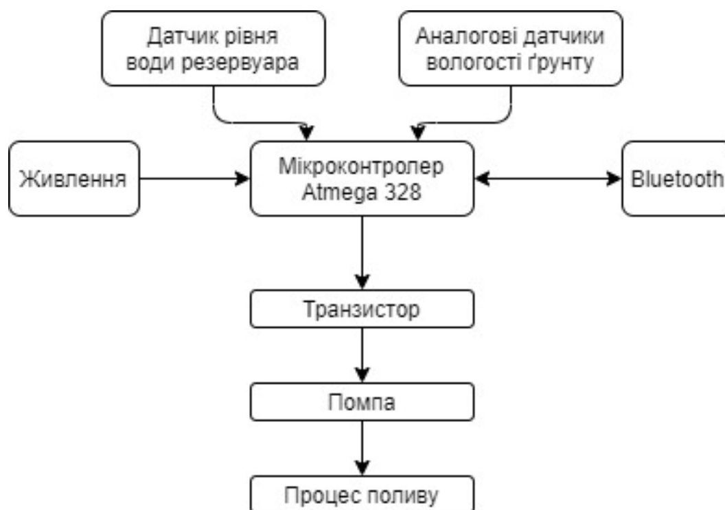
Рис. 2.1 - Структурна схема системи поливу
