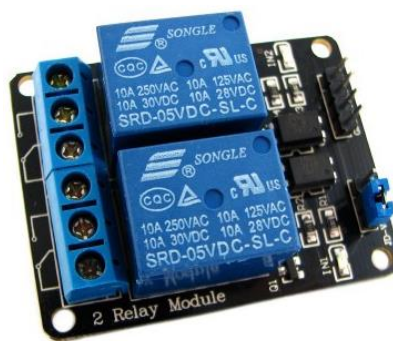
Рисунок 21 - 2-х канальний модуль-реле SRD-05VDC-SL-C
