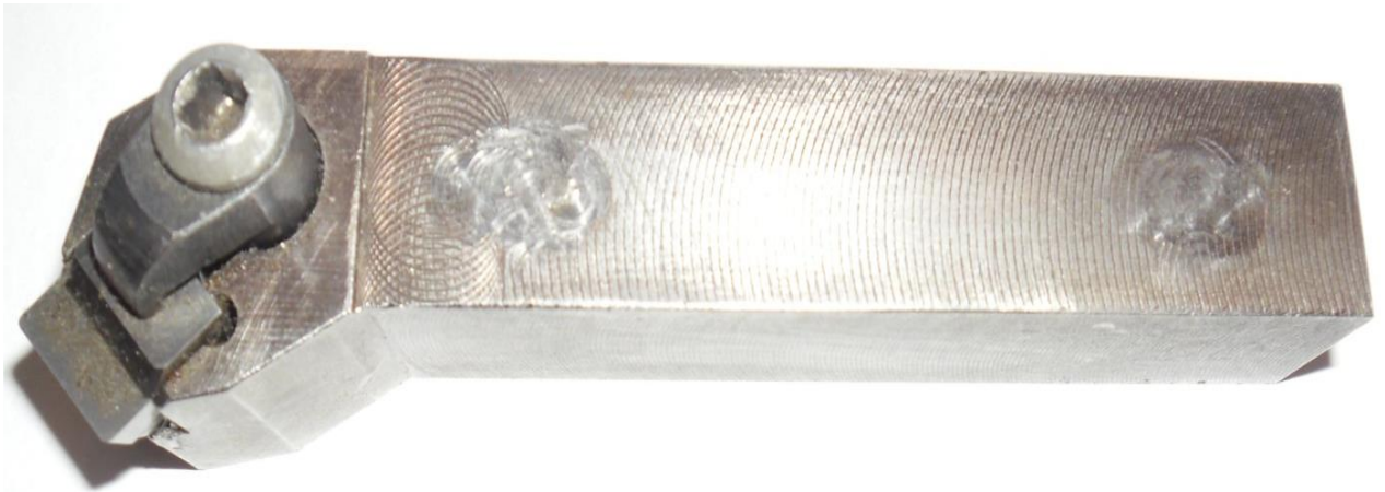
Рисунок 3.2 – Різець токарний збірний 92.2102-0051
