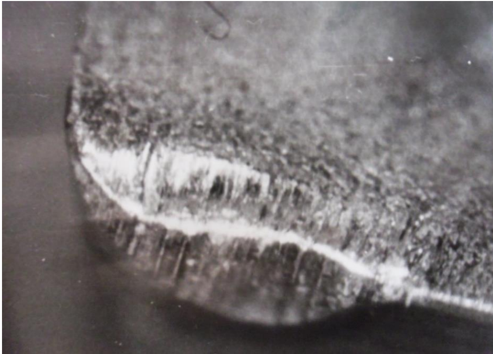
Рисунок 3.5 – Вигляд зносу ріжучого інструменту при точінні сплаву ХН67МВТЮ інструментом з твердого сплаву ВК6М при швидкості різання V = 1,1 м/с ( S_o = 0,11 мм/об, t = 0,5 мм, МОР: 5 % МХО-64а)
