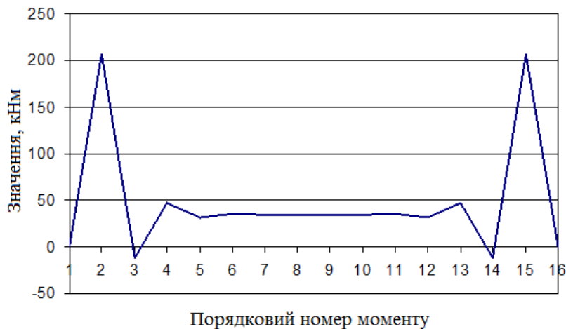
Рисунок 2.16 – Розподіл моментів згину по довжині балки
