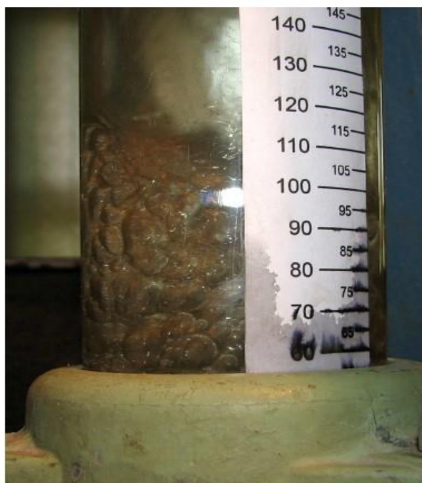
Рисунок 2.5 - Робота тарілки провального типу в режимі однорідного
