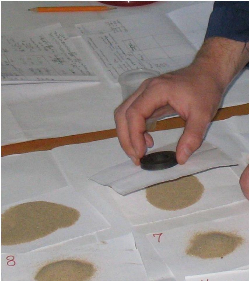
Рисунок 3.3 - Відбір головного компонента магнітом
