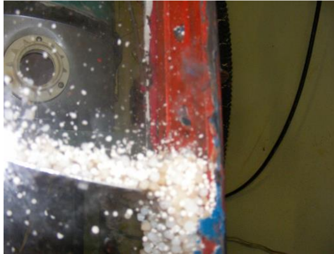
Рисунок 2.4 – Робота сушарки у режимі гравітаційного падаючого шару дисперсного матеріалу
