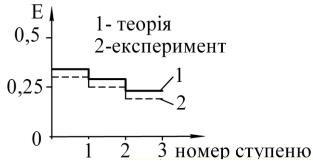
Рисунок 3.1 – Вплив кута нахилу по-лиці на ефективність процесу сушіння ( \gamma = \gamma_0 + (15-17)^\circ , X/L = 0,3 ; \psi = 20\% ; d_{відн} = d_{омв} ; G_{суш}/G_M = 2 )
