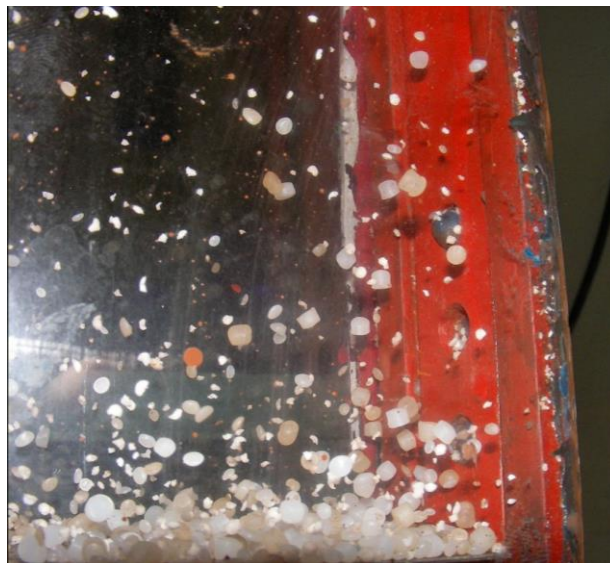
Рисунок 2.8 – Другий перехідний режим роботи сушарки
