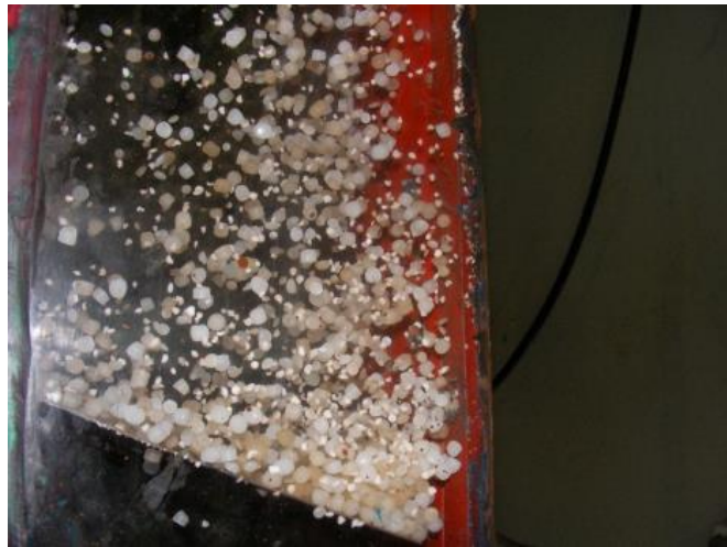
Рисунок 2.9 – Робота сушарки у режимі винесення дисперсного матеріалу
