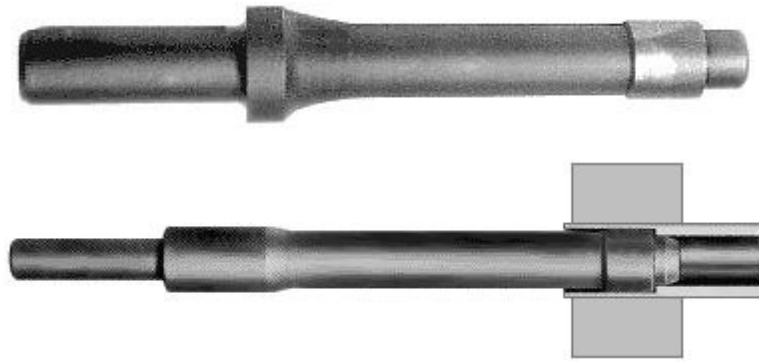
Рис. 4.5. – Оправлення для видалення з трубних решіток труб після їх обробки зенковки
