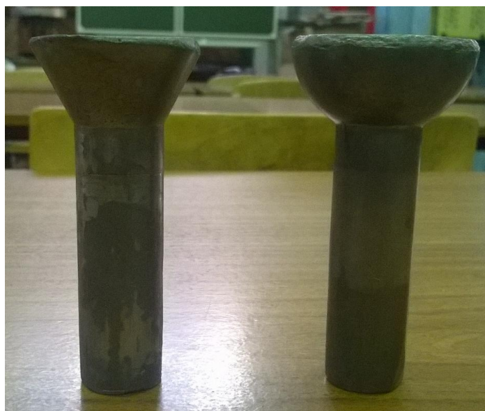
Рисунок 3.19 - Отримана в результаті фізичного моделювання висадки кування зі сталі 45 після попереднього штампувального переходу (зліва) і після остаточного формування півсфери (праворуч)
