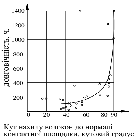
Рисунок 1.4 - Залежність довговічності підшипника від кута нахилу волокон до нормалі контактної площадки
