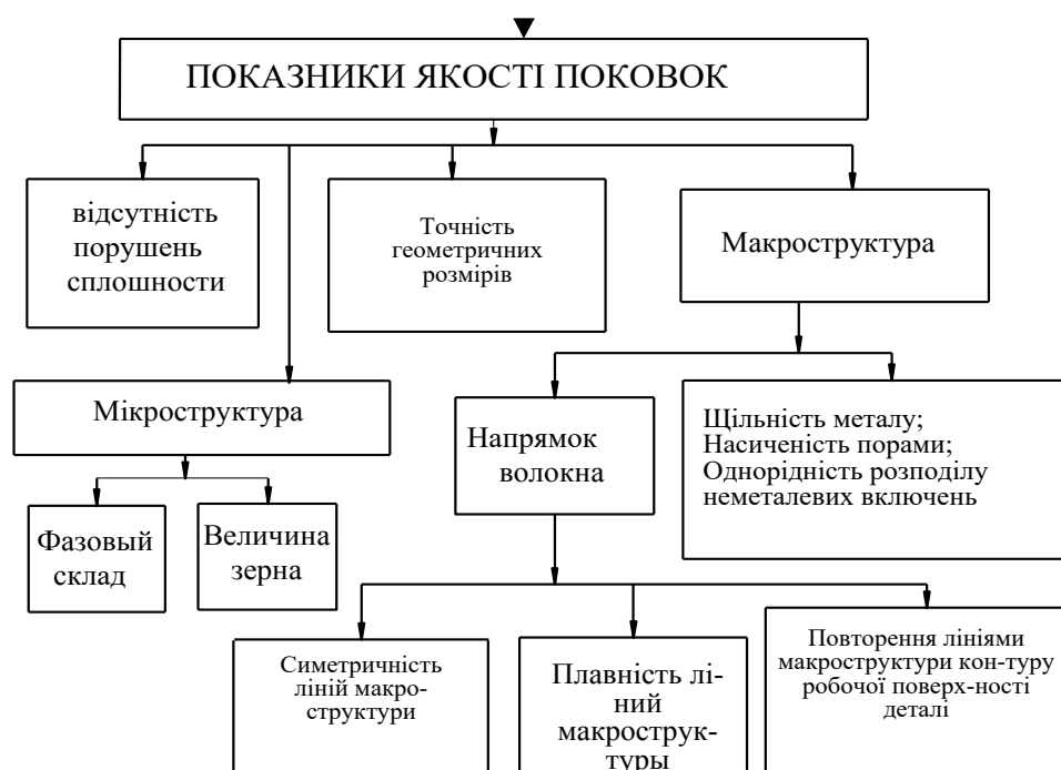
Рисунок 1.1 - Схема зв'язку якості поковок з характеристиками макро- і мікроструктури
