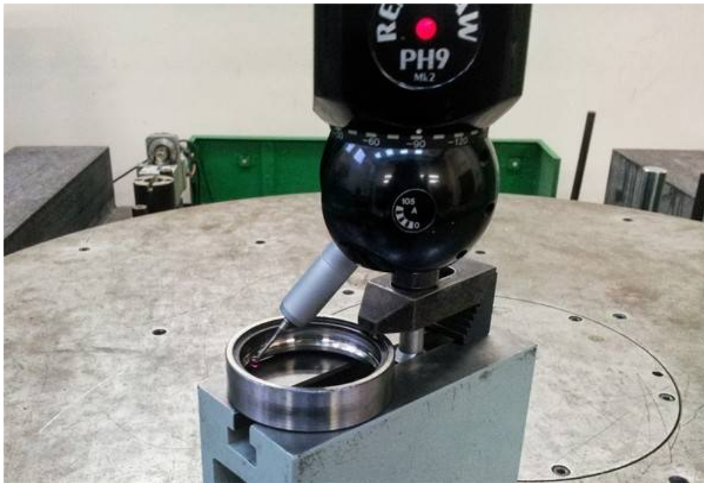
Рисунок 4.15- Вимірювання зовнішнього кільця підшипника 206А
