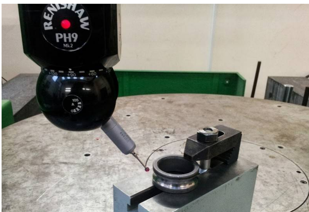
Рисунок 4.12 - Вимірювання внутрішнього кільця підшипника 206А
