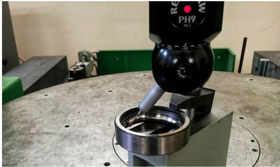
Рисунок 4.7 - Вимірювання зовнішнього кільця підшипника 307а
