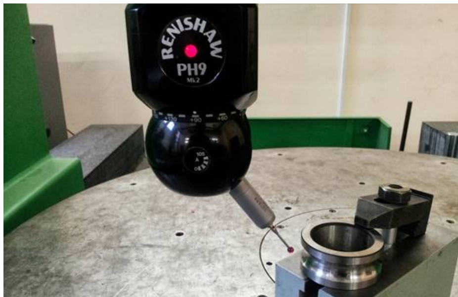
Рисунок 4.4 - Вимірювання внутрішнього кільця підшипника 307А
