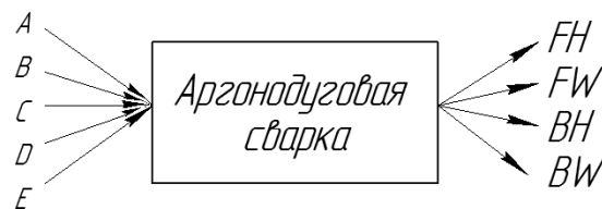
Рисунок 1.4 – Вхідні і вихідні параметри нейромережі [122]: (А) - швидкість зварювання, (В) - швидкість подачі дроту, (С) - % зміст елементів в дроті, (D) - зазор між деталями, (Е) - зварювальний струм, (FH) - посилення зварного шва, (FW) - ширина зварного шва, (BH) - висота зворотного валика, (BW) - ширина зворотного валика
