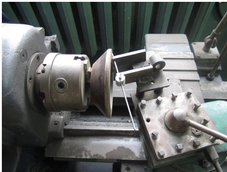
Рисунок 2.4 – Пристосування для заточування електродів
