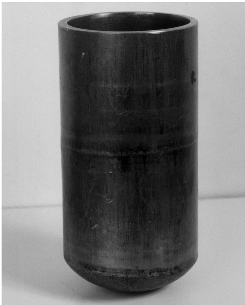
Рисунок 4.8 – Штапована заготовка циліндра приводу засувки
