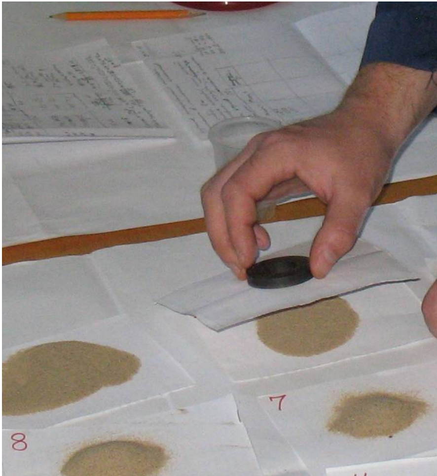
Рис.3.3. Відбір ключового компонента за допомогою магніту
