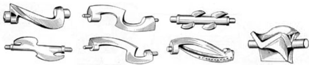
Рис. 1.6-4 Форма лопатей двохвалькових змішувачів для паст з Z-подібними лопатями
