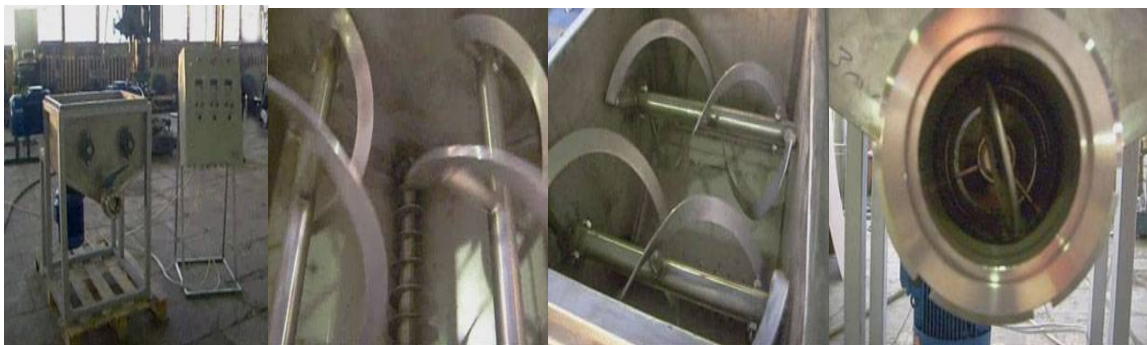
Рис. 1.1-8Стрічковий змішувач з двома горизонтальними валами і шнековим вивантаженням.
