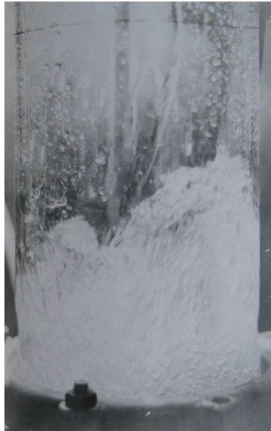
Мал. 10. Робота тарілки провального типу в режимі рухомого газорідного шару: тарілка № 10 (таблиця 1),
