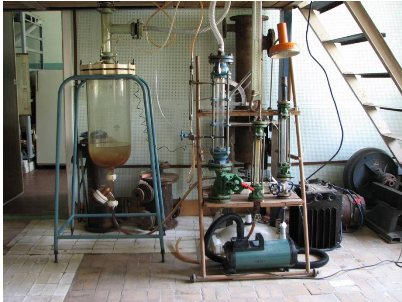
Мал. 6. експериментальна установка для гідравлічних і кінетичних досліджень тарілок провального типу D=0.057
