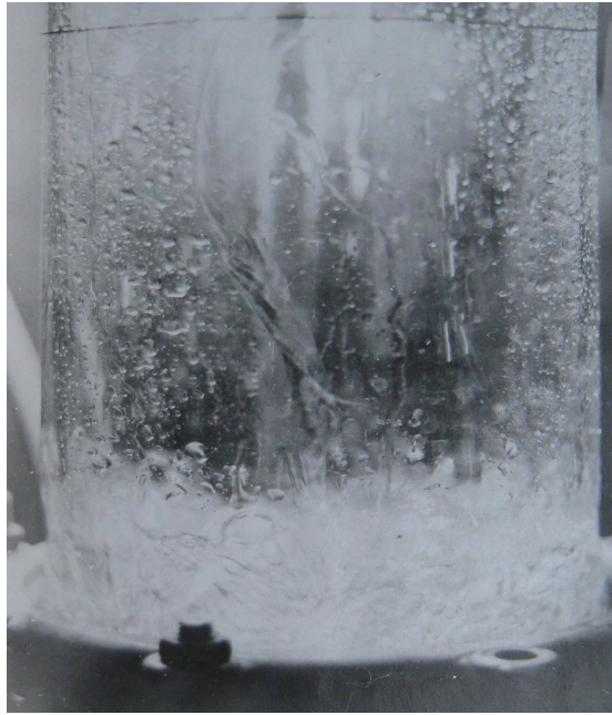
Рис. 7 Робота тарілки провального типу в режимі однорідного барботажного шару: тарілка № 10 (таблиця 10),
