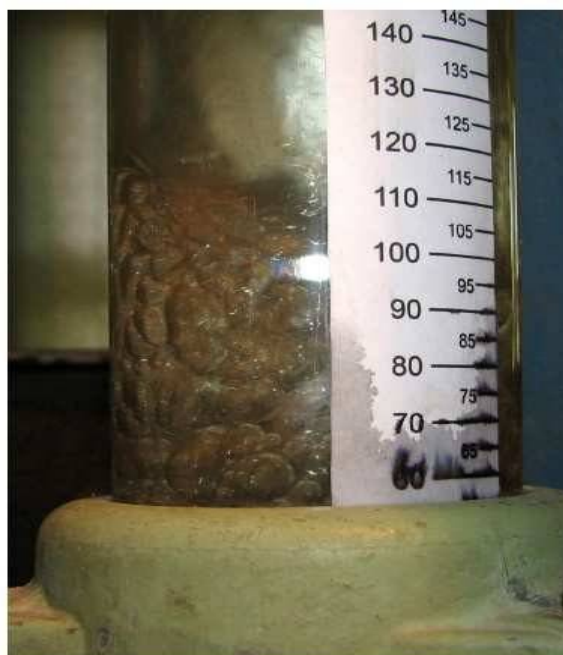
Рис. 5. Робота тарілки провального типу в режимі однорідного барботажного шару: тарілка № 21 (таблиця 10), L = 13,5 \text{ м}^3/(\text{м}^2 \cdot \text{год}) , w = 0,56 \text{ м/с} .
