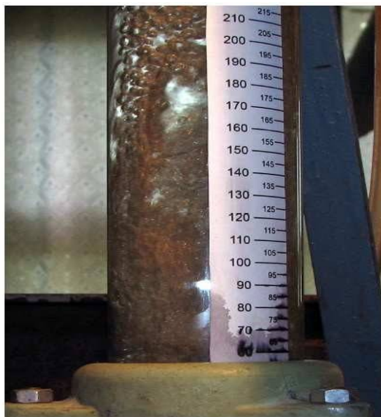
Рис. 6. Робота тарілки провального типу в режимі рухомого газорідного шару: тарілка № 21 (таблиця 10), L = 13,5 \text{ м}^3/(\text{м}^2 \cdot \text{год}) , w = 1,44 \text{ м/с} .
