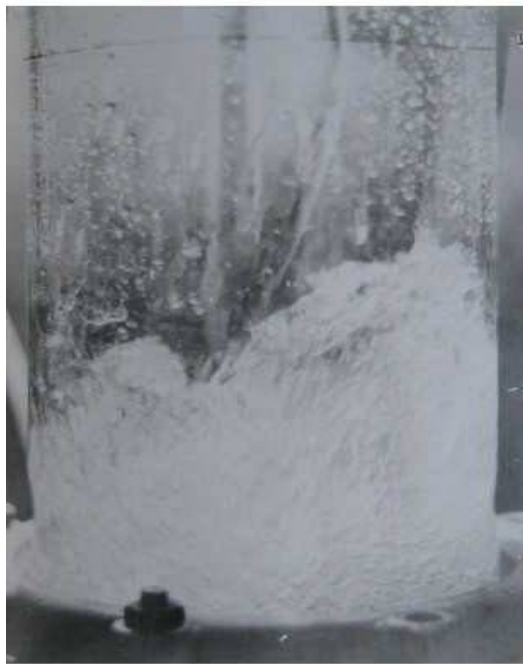
Рис. 8 Робота тарілки провального типу в режимі рухомого газорідного шару: тарілка № 10 (таблиця 10),
