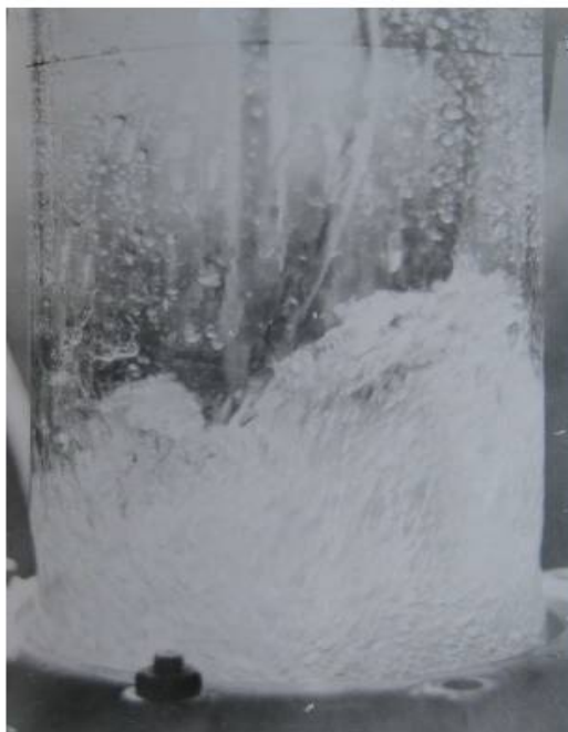
Рисунок 8. Робота тарілки провального типу в режимі рухомого газорідинного шару: тарілка № 10 (таблиця 10),
