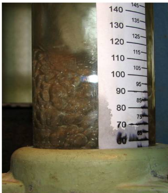
Рисунок 5. Робота тарілки провального типу в режимі однорідного барботажного шару: тарілка № 21 (таблиця 10), L = 13,5 \text{ м}^3/(\text{м}^2 \cdot \text{год}) , w = 0,56 \text{ м/с} .
