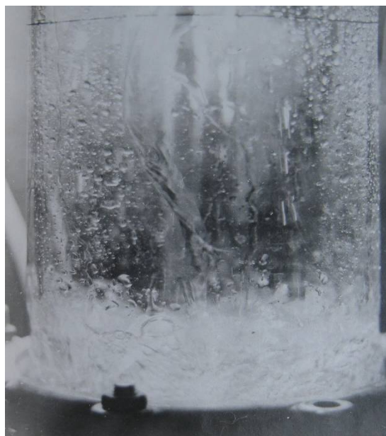
Рисунок 7. Робота тарілки провального типу в режимі однорідного барботажного шару: тарілка № 10 (таблиця 10), L = 12,7 \text{ м}^3/(\text{м}^2 \cdot \text{год}) , w = 0,72 \text{ м/с} .
