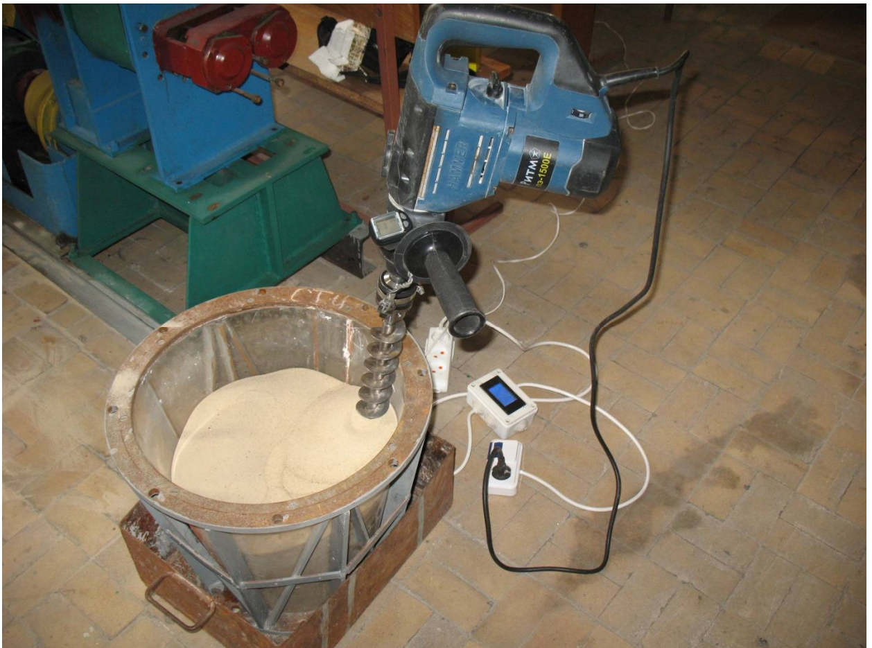
Рис. 3.4. Експериментальна установка для дослідження змішувачів з вертикальним ротором
