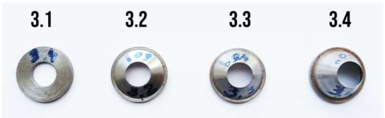
Рис. 3.4 – Елементи дослідження, діафрагми та дифузори \varnothing 12 мм .
