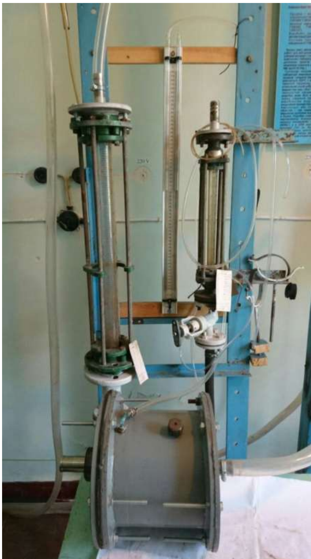
Рис.3.2 – Экспериментальна установка (компресор не показаний)
