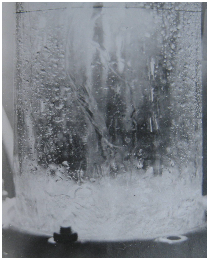
Рис. 1.4. Робота тарілки провального типу в режимі однорідного барботажного шару: тарілка № 10 (таблиця 10),
