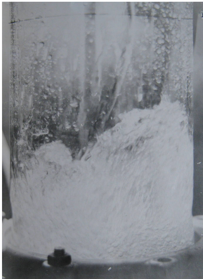
Рис. 1.5. Робота тарілки провального типу в режимі рухомого газорідинного шару: тарілка № 10 (таблиця 10), L = 12,7 \text{ м}^3/(\text{м}^2 \cdot \text{г}) , w = 0,83 \text{ м/с}
