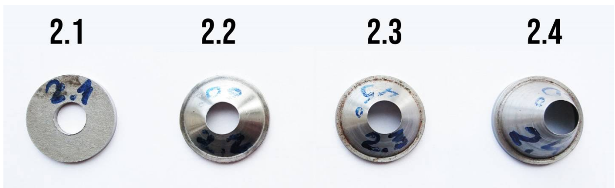
Рис. 3.4 – Елементи дослідження, діафрагма та дифузори \varnothing 10
