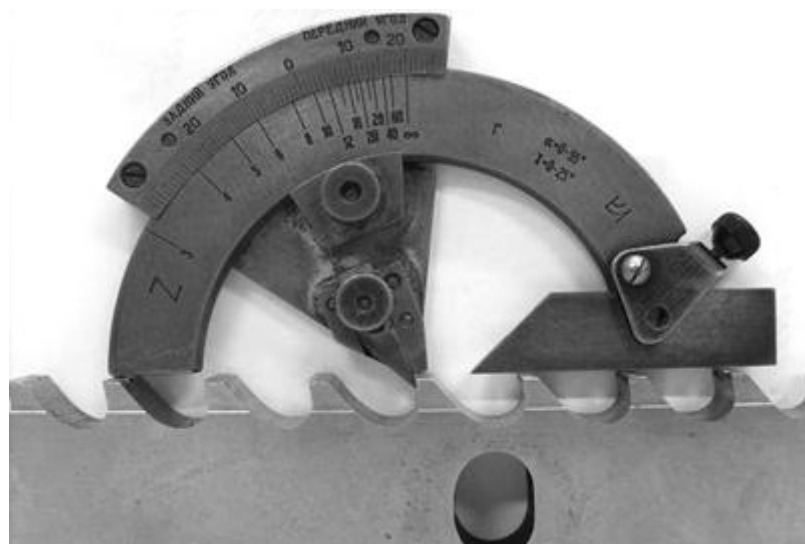
Рисунок 1.16 - Схема вимірювання переднього кута ( \gamma ) шпонкової протяжки на кутомірі 2УРИ
