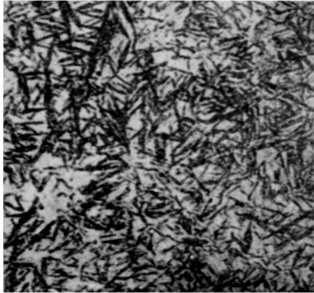
Рисунок 1.19 - Структура цементованого шару сталі 18ХГТ після гартування у маслі від температури 860 - 880°C, \times 500 : мартенсит гарту + залишковий аустеніт (карбідна сітка відсутня), \times 1000
