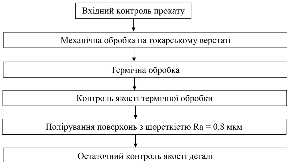
Рисунок 1.3 - Маршрутна технологія виготовлення деталі “вал”
