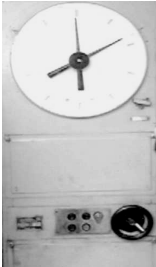
Рис. 3.2. Вимірювання прогину пружини під статичним навантаженням на гідравлічному пресі П-125
