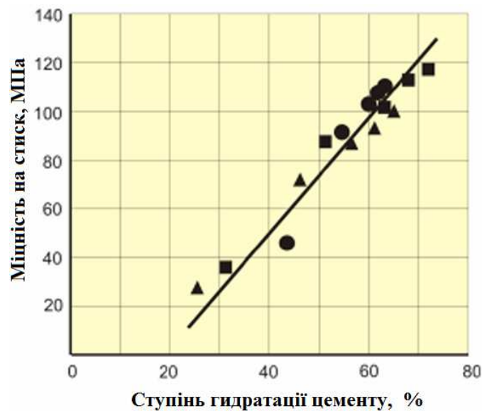
Рис. 2.17. Залежність міцності цементного каменю з МБ від ступеня гідратації цементу:
