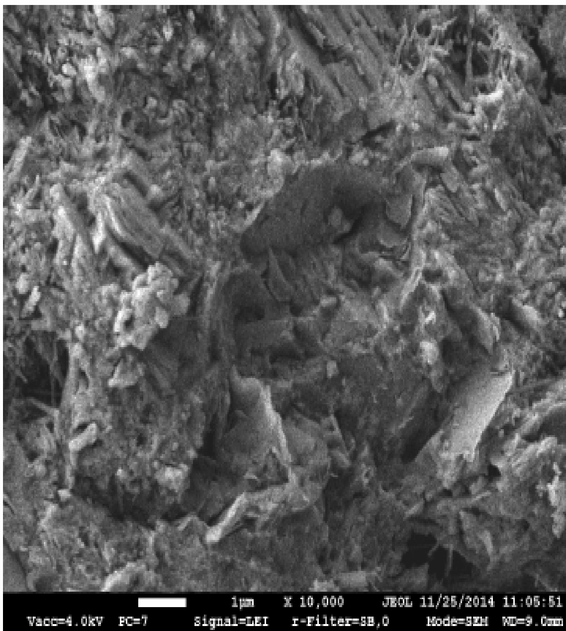
Рис. 3.9. Микроструктура цементного бетона, модифицированного 0,5% "Ethacryl HF" и 3% МК – фрагмент микроструктуры повышенной плотности с заблокированными пластинчатыми новообразованиями.
