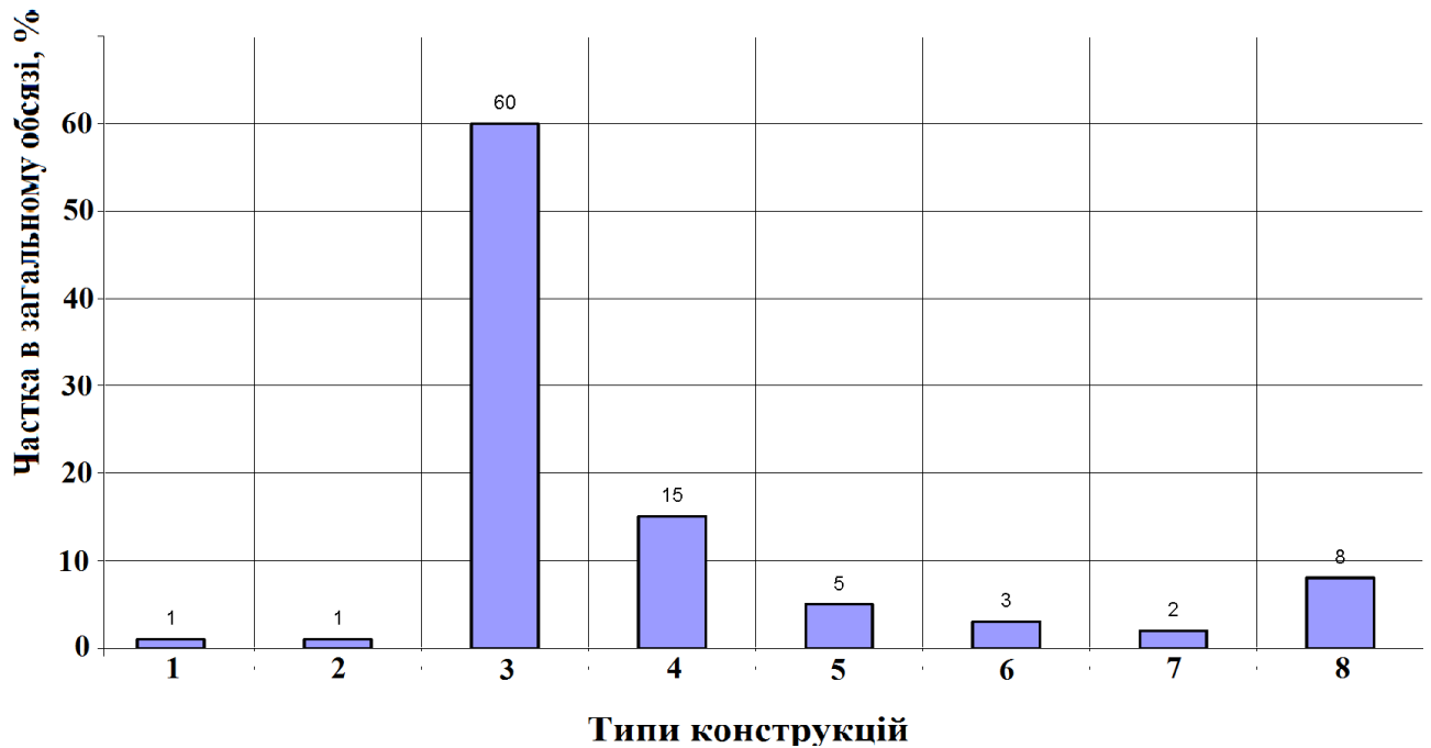
Рис. 2.5. Діаграма частоти повторюваності конструктивних рішень стін будівель, що реконструюються : 1- глиняні; 2- дерев'яні; 3- цегляні; 4- легкобетонні; 5- багатошарові з повітряним прошарком; 6- багатошарові з утеплювачем; 7- залізобетонні; 8- інші.
