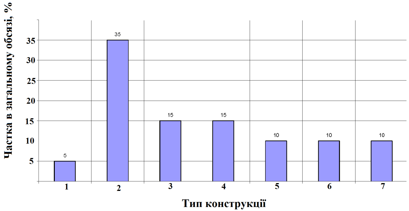
Рис. 2.4. Діаграма частоти повторюваності конструктивних рішень фундаментів будівель, що реконструюються: 1-бутові; 2- цегляні; 3- залізобетонні монолітні; 4- залізобетонні збірні; 5- стовпчасті (залізобетонні); 6- пальові; 7- Інші
