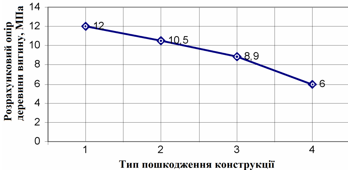
Рис. 2.15. Залежність міцності дерев'яного перекриття (розрахунковий опір деревини згину) від наявності пошкоджень і деформацій конструкцій. Тип пошкоджень: 1 – без пошкоджень; 2 – поздовжні тріщини; 3 – деструктивна гниль; 4 – поперечні тріщини
