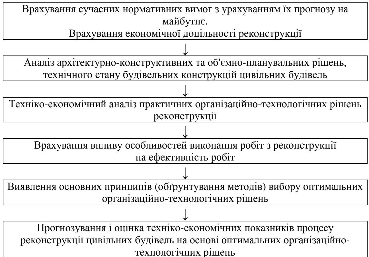
Рис. 1.5. Логічна блок-схема методологічної послідовності і взаємозв'язків складових елементів реконструкції цивільних будівель
