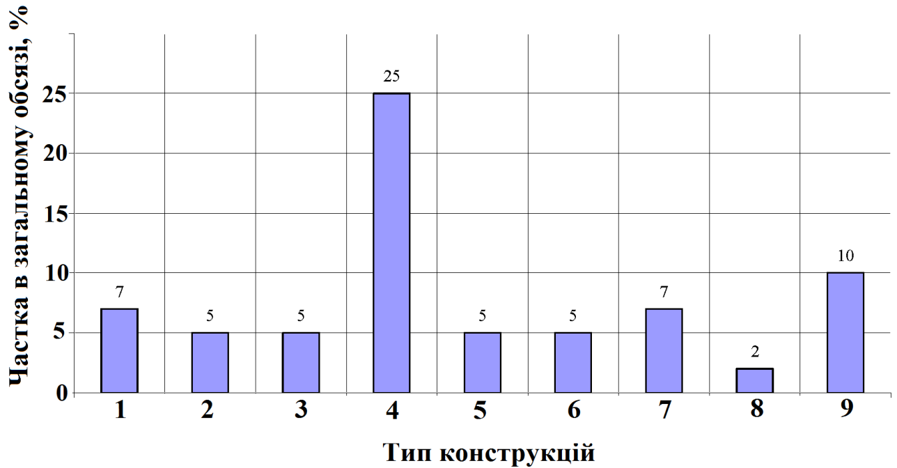
Рис. 2.6. Діаграма частоти повторюваності конструктивних рішень перекриттів реконструйованих будівель: 1- дерев'яні з глиняного засипанням; 2- цегляні склепіння по металевих балках; 3 - залізобетонні склепіння по металевих балках; 4-дерев'яні з тепло-, звукоізоляцією; 5- металеві балки з дерев'яним заповненням; 6- монолітні залізобетонні; 7- дрібнорозмірні плити по збірних залізобетонних балках; 8- збірні залізобетонні; 9- інші.
