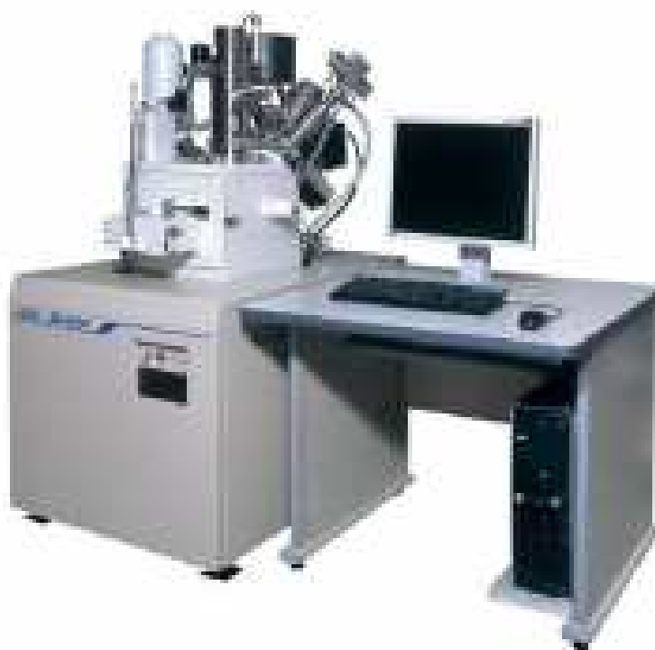
Рис. 2.3. JIB-4500 – двопроменева (іонно-електронна) система з термоемісійним джерелом електронів LaB6
