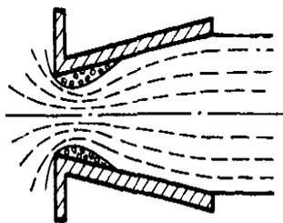
Рис. 3.10. Диффузорный насадок
