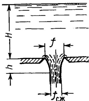
Рис.3.2. Истечение через отверстие в тонкой стенке
