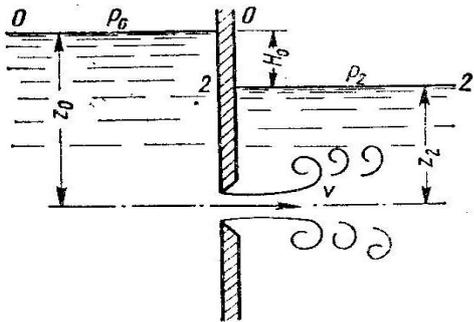
Рис. 3.6. Истечение через затопленное отверстие
