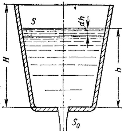
Рис. 3.5. Схема опорожнения резервуара
