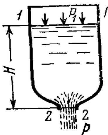
Рис.3.1. Истечение из донного отверстия
