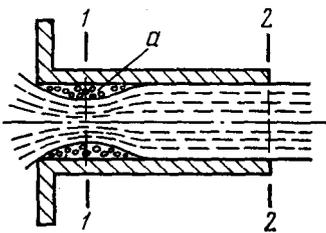
Рис.3.8. Истечение через внешний цилиндрический насадок
