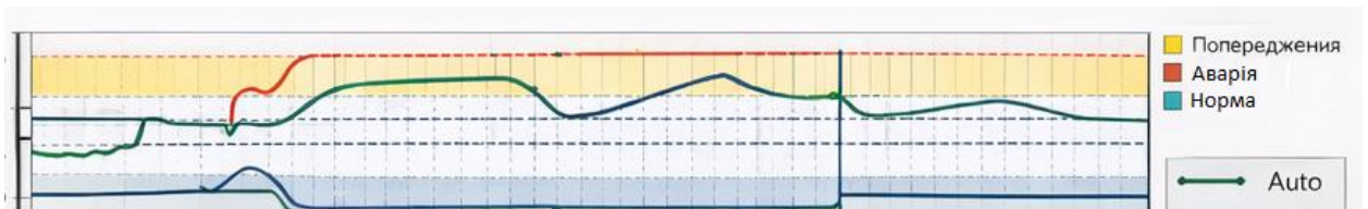
Рисунок 6.5 - Графічне представлення перехідних процесів вузла відпарювання у динамічному режимі
