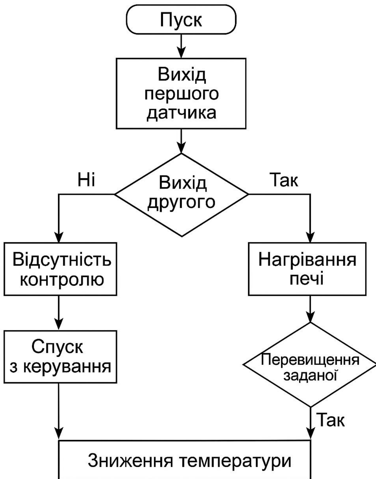
Рисунок 2.3 - Блок-схема алгоритмів керування Е-132
