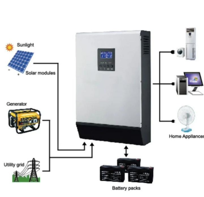
Рисунок 3 – Гібридна система безперебійного живлення
