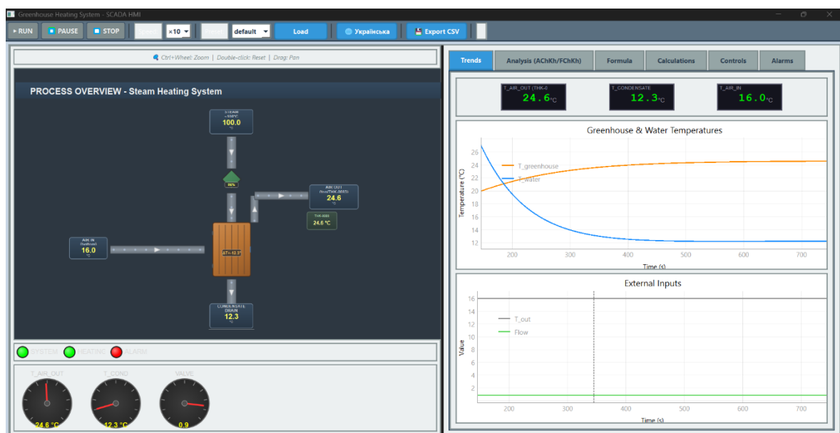
Рисунок 4.11 - Запуск імітаційної моделі системи керування мікрокліматом у власному програмному інструменті з візуалізацією технологічного процесу та засобами аналізу
