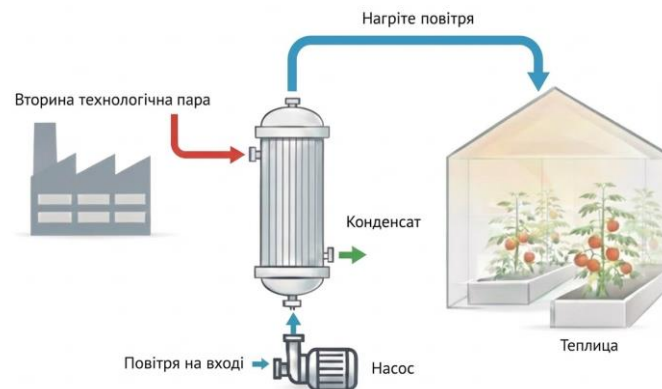
Рисунок 1.2 - Принципова схема використання вторинної технологічної пари для опалення теплиці.
