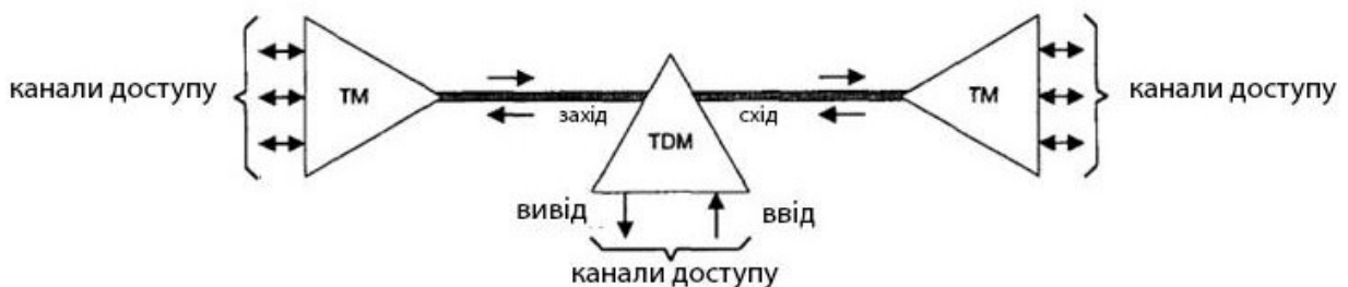
Рисунок 2.4 – Топологія простий послідовний ланцюг
