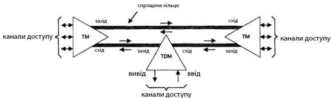
Рисунок 2.5 – Топологія ланцюг з резервуванням 1+1
