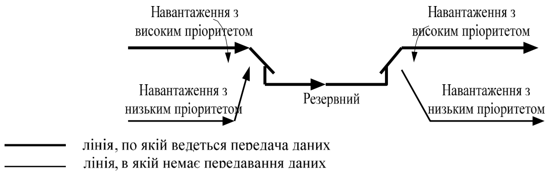
Рисунок 3.5 – Схема переключення 1 : 1, резервний тракт використовується для навантаження з високим пріоритетом після відключення навантаження з низьким пріоритетом
