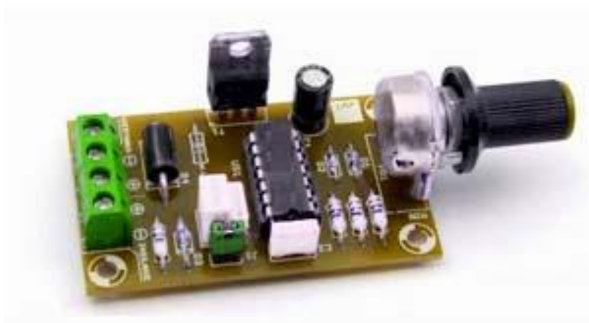
Рисунок 1. Зовнішній вигляд простого регулятора обертів електродвигуна
