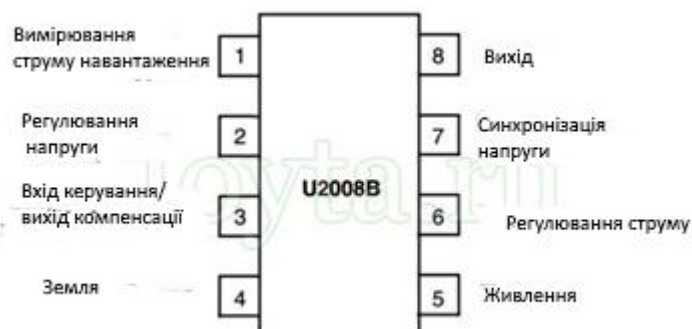
Рисунок 4. Розпинування та призначення виводів U2008
