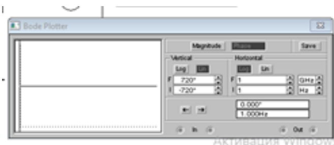
Рисунок 4.11. При під'єднанні джерела постійної напруги до ОП МС33171 на екрані бодіплотера фазова характеристика
