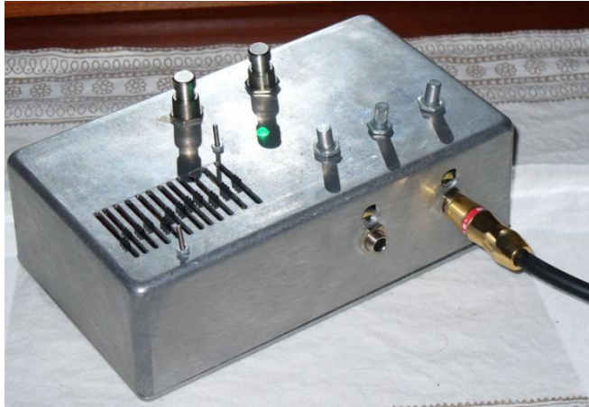
Рис.4.8. Вхідний і вихідний роз'єми встановлені на коробці, світлодіод горить зеленим кольором, що вказує на те, що блок спотворень включений і блок еквалайзера знаходиться в обході.
