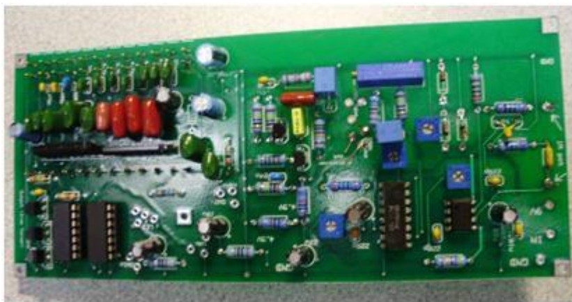
Рис. 4.4. Вигляд друкованої плати знизу з припаяними деталями.
