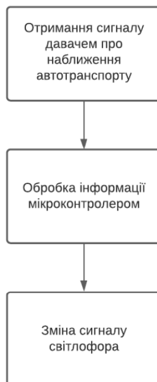
Рисунок 2.3 – Основні етапи роботи автоматизованого управління світлофором
