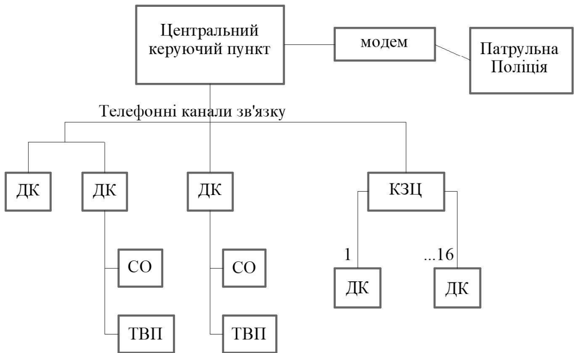
Рисунок 1.3 – Узагальнена структурна схема КІСУ потоком автотранспорту третього рівня
