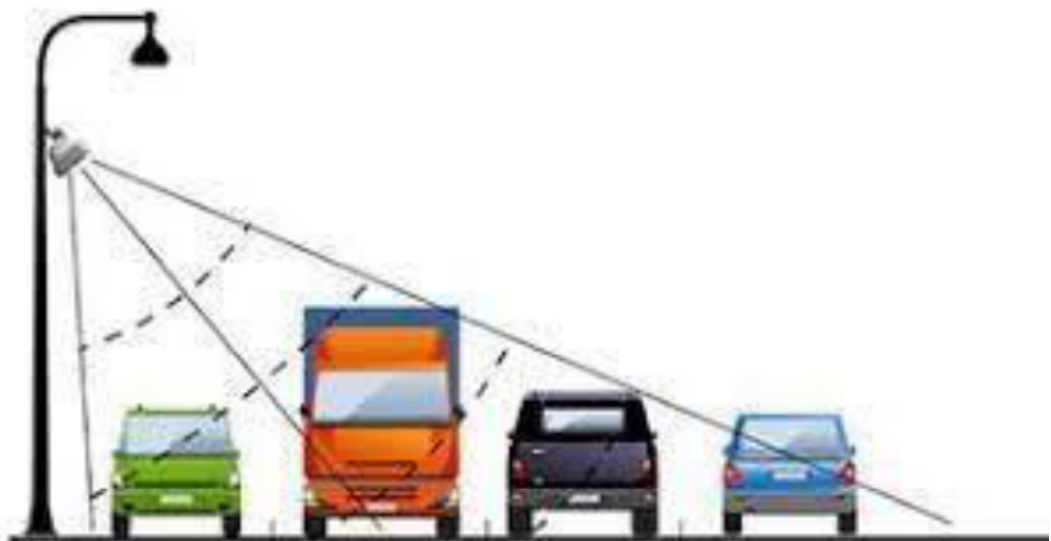
Рисунок 1.4 – Приклад встановлення детектора на стовпі освітлення
