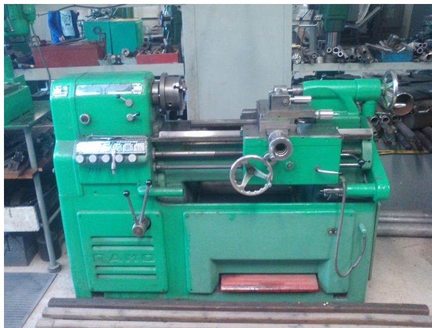
Рисунок 11 - Токарний верстат РАМО модель Т37
