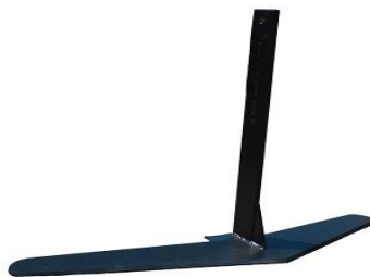
Рисунок 1.2 – Робочий орган плоскоріза П-700 для боротьби з бур'янами.
