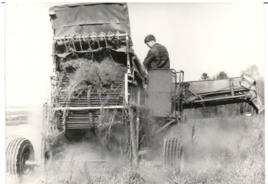
Рисунок 1.12 - Картоплезбиральний комбайн з відцентрово-вижимним сепаратором
