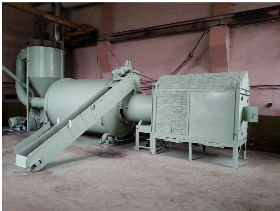
Рисунок 2.10 – Сушильний комплекс подрібненої біологічної сировини барабанного типу продуктивністю до 1000 кг/год
