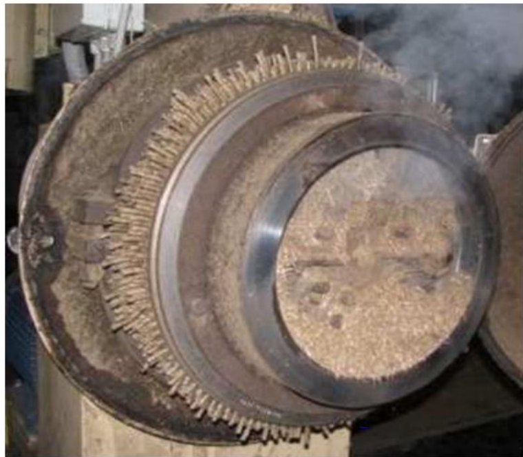
Рисунок 2.22 – Сформовані паливні гранули на виході з циліндричної матриці
