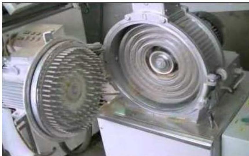
Рисунок 2.7 – Конструкція дезінтегратора з двома електричними двигунами
