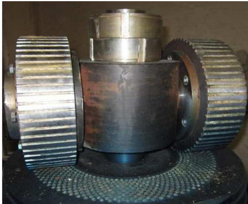
Рисунок 2.19 – Конструкція преса-гранулятора з двома притискувальними роликами
