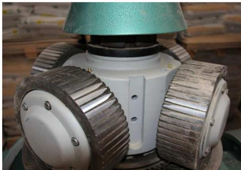
Рисунок 2.20 – Конструкція преса-гранулятора з чотирма роликами
