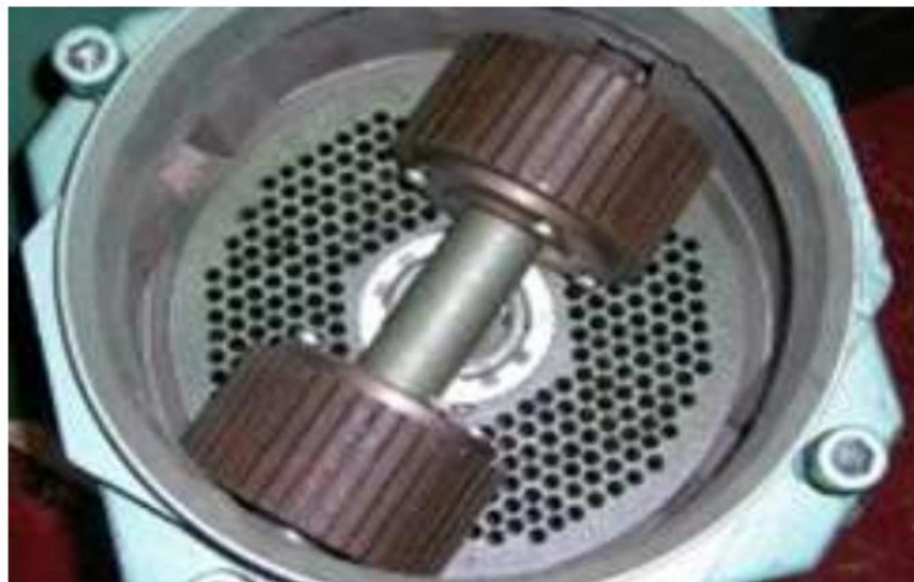
Рисунок 2.17 – Робоча матриця з роликами притискувальними, розташованими в корпусі преса-гранулятора
