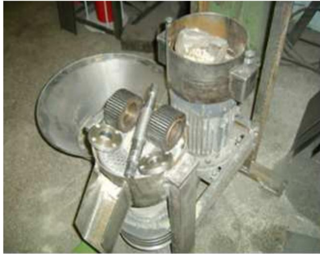
Рисунок 2.16 – Варіант компоновки та роботи преса-гранулятора (у розібраному стані) і електричного привода
