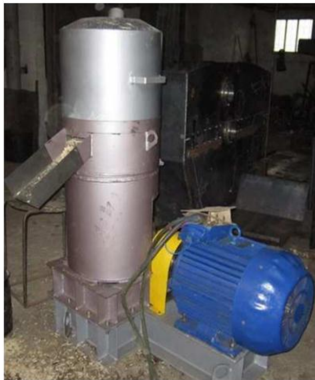
Рисунок 2.15 – Варіант компоновки електричного привода і прес-гранулятора на загальній рамі
