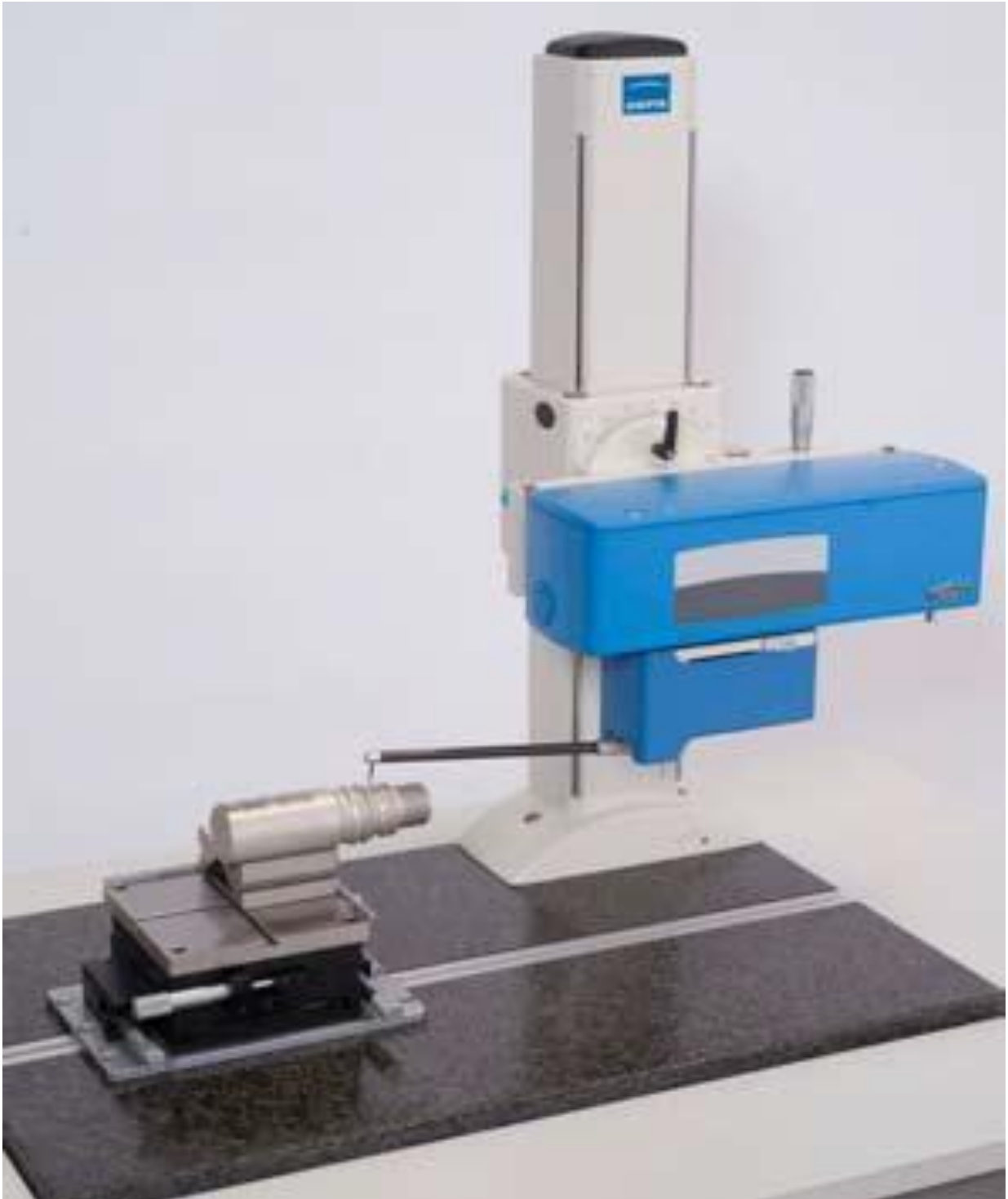
Рисунок 3.6 – Апарат для контролю якості мікрорельєфу поверхні
