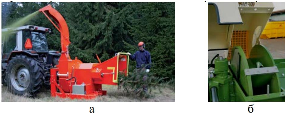
Рисунок 2.7 - Подрібнювачі з дисковими різальними пристроями для виробництва каліброваної тріски: а – подрібнювач OL 2700 NT;
