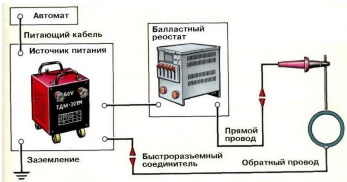
Рисунок 2.1 - Процес дугового наплавлення штучними електродами
