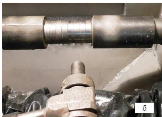
Рисунок 2.8 - Устаткування для піскоструминної обробки деталей обертання : компресор з піскоструминною камерою (а); оброблювана деталь з соплом піскоструминного апарату (б)
