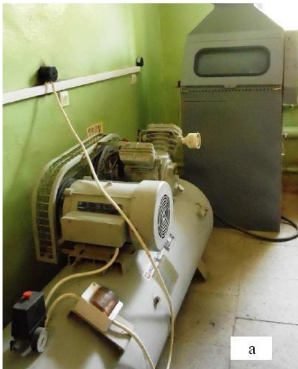
Рисунок 2.8 - Устаткування для піскоструминної обробки деталей обертання : компресор з піскоструминною камерою (а); оброблювана деталь з соплом піскоструминного апарату (б)
