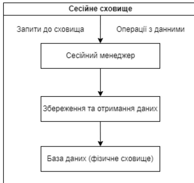
Рис. 3.3 Схема роботи сесійного сховища
